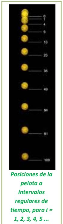
1 Una lámpara estroboscópica es un instrumento que ilumina una escena durante intervalos regulares de tiempo. Si utilizamos este tipo de luz sobre un movimiento repetitivo, como la rotación de una rueda, y el intervalo coincide con un período completo de movimiento, el objeto parecerá estático al observador.
