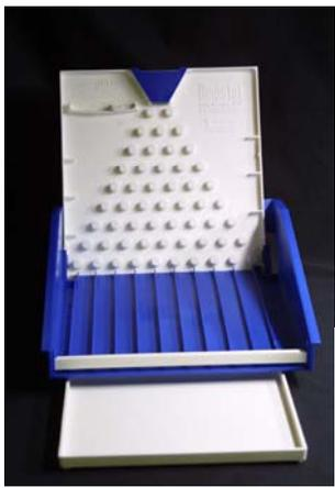
El dispositivo que aparece a la izquierda se denomina *aparato de Galton*. Su funcionamiento es el siguiente: cuando se introduce una bola por el embudo superior, va cayendo por los huecos que existen en cada fila. En cada paso puede caer por el hueco que tiene a su derecha o por el que tiene a su izquierda con igual probabilidad, de forma que es imposible, cuando ponemos una bola en el embudo predecir en cuál de los carriles inferiores acabará cayendo.
