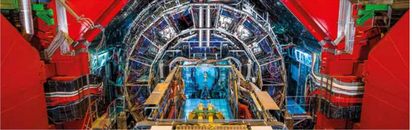
El LHC, emplazado en el CERN, es el acelerador de partículas más grande y energético del mundo. Se trata de un túnel circular de 27 km de longitud por el interior del cual se aceleran haces de protones en sentidos opuestos a velocidades próximas a la luz. Cuando las partículas colisionan, producen altísimas energías a escala subatómica que permiten simular eventos que ocurrieron inmediatamente después del Big Bang.
