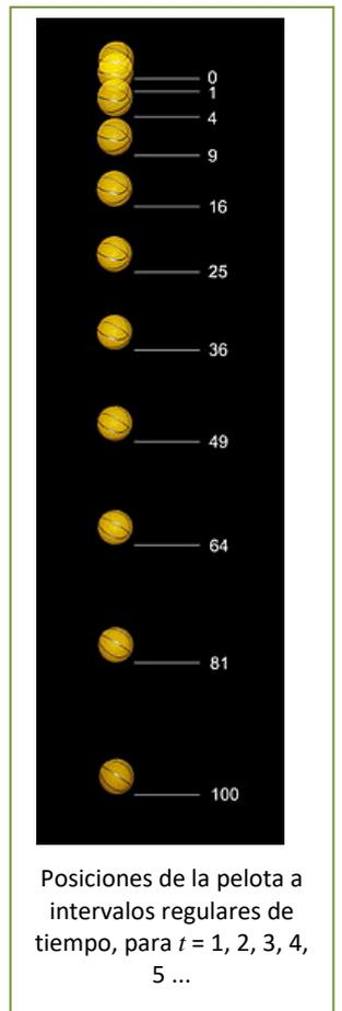
1 Una lámpara estroboscópica es un instrumento que ilumina una escena durante intervalos regulares de tiempo. Si utilizamos este tipo de luz sobre un movimiento repetitivo, como la rotación de una rueda, y el intervalo coincide con un periodo completo de movimiento, el objeto parecerá estático al observador.
