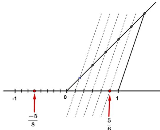
Fíxate que para dividir en 6 partes iguais só hai que marcar 5 puntos intermedios a igual distancia, sempre un menos. Para dividir en 8 partes iguais marcamos 7 puntos intermedios.
