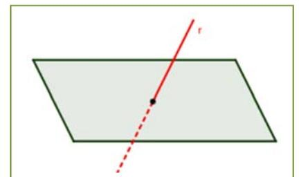
3. Si  $rg(M) = rg(M^*) = 3 \Rightarrow S.C.D. \Rightarrow$  El sistema tiene una única solución. La recta y el plano son **secantes** y se cortan en un punto.
